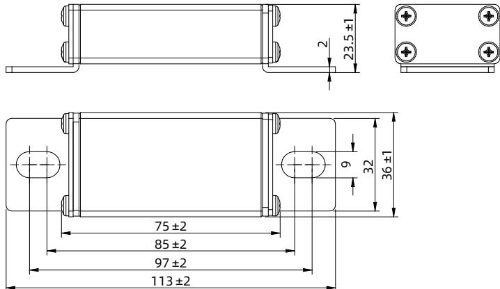
安装方式: BK (刀型连接)
